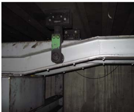
Fig.5. Principiul de schimbare a înalțimii benzii
