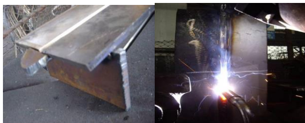
Fig. 5. Plăcute tehnologice de capăt și sudarea propriu zisa
