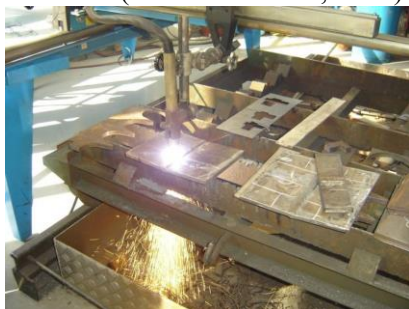
Fig. 6. Debitarea cu plasma, masina Novitome
