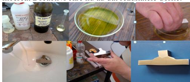
Fig. 10. Preparare reactiv pentru proba sudată cap la cap și înglobată în rășina: 10g (\text{COOH})_2 \cdot 2\text{H}_2\text{O} ; 100ml \text{H}_2\text{O}_2 și efectuare atac electro-chimic, utilizând sursa curent stabilizată TXN 1502
