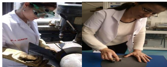
Fig. 7. Curatare și slefuire probe
