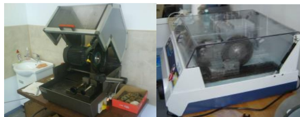
Fig. 8. Mașina de debitat pentru de grosare și precizie Remet TR100 Evolution respectiv Isomet 4000, laborator LAMET, UPB
