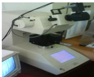
Fig. 16. Microdurimetru Shimadzu HMV 2T (Laborator LAMET)
