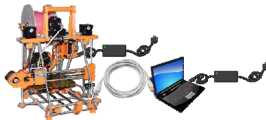
Fig. 17. Conectarea și alimentarea imprimantei 3D
